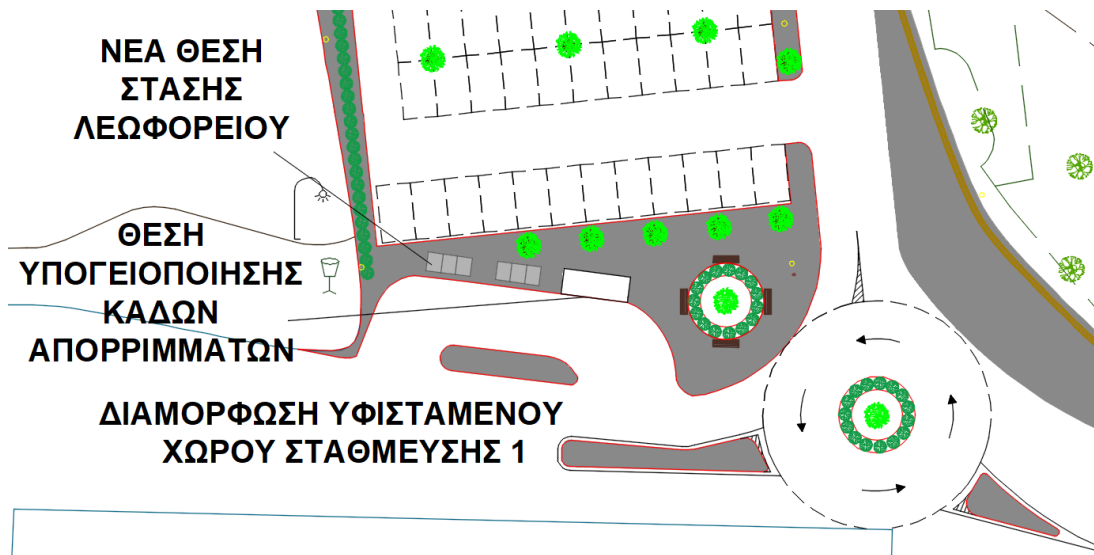
Εικόνα 232. Θέση εγκατάστασης υπογειοποιημένου συστήματος συλλογής απορριμμάτων
