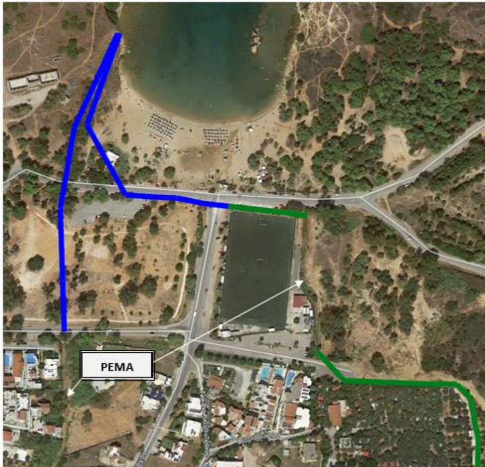
Εικόνα 176. Προτεινόμενοι νέοι αγωγοί ομβρίων στα όρια της περιοχής μελέτης σύμφωνα με την «Υδραυλική μελέτη ομβρίων οικισμού Δαράτσου Δ.Ε. Νέας Κυδωνίας» (με μπλε απόχρωση = υφιστάμενοι αγωγοί, με πράσινη γραμμή = προτεινόμενοι νέοι αγωγοί εντός περιοχής μελέτης)
